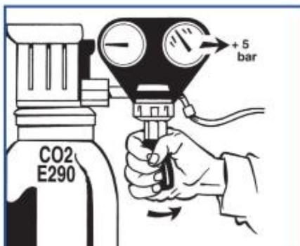
8. Augmenter la pression de CO<sub>2</sub> en tournant la molette noire vers la droite jusqu'à ce que l'aiguille de droite atteigne 5 bar.
