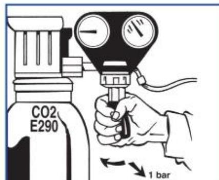
9. Rebaissier la pression de CO<sub>2</sub> en tournant la molette noire doucement vers la gauche jusqu'au moment où l'aiguille ne redescend plus = se stabilise.
